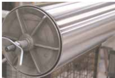
Alle Rohre erhielten einen speziellen Oberflächenschliff
